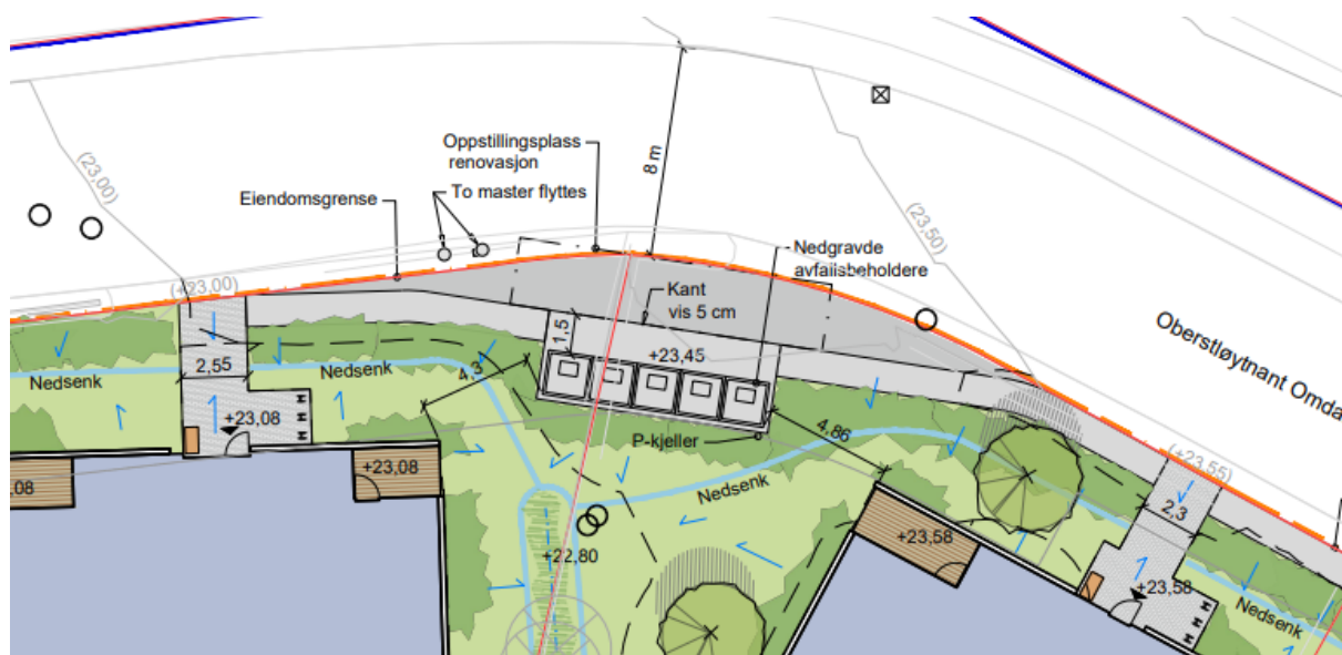
Figur 33. Utsnitt av illustrasjonsplanen som viser forslag til løsning for plassering av avfallscontainere og oppstillingsplass for renovasjon sbil.
