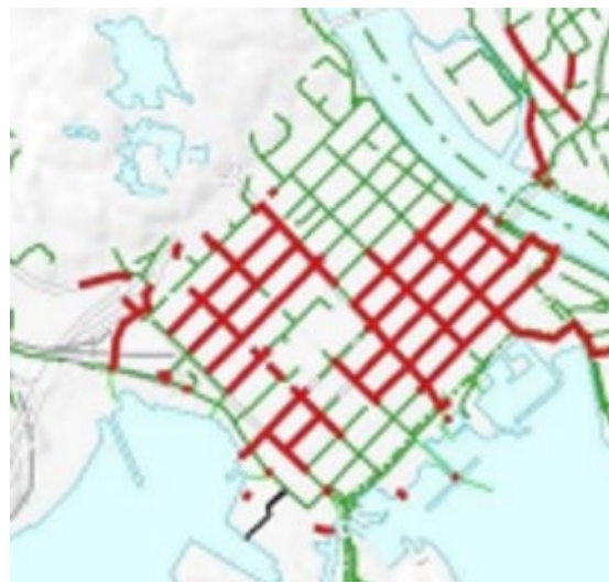
2022 – grønne linjer viser hvor det er gjennomført separering av avløp og spillvann
