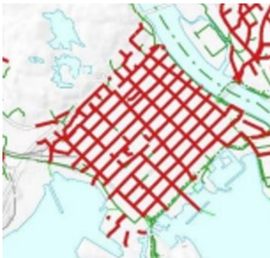
2009 – røde linjer viser felles avløp og spillvann
