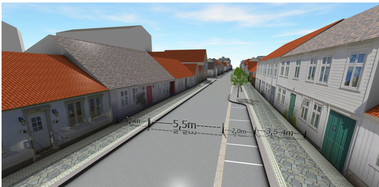
Nytt forslag til gatetverrsnitt av Holbergs gate. Utsnitt vist mellom Rådhusgata og Gyldenløves gate.
