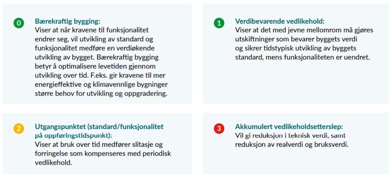
Figur 9:: Tekst til figur 7 Sammenheng mellom vedlikehold og utvikling av kvalitetsnivå over tid. (Kilde: S. Bjøberg, Multiconsult).
