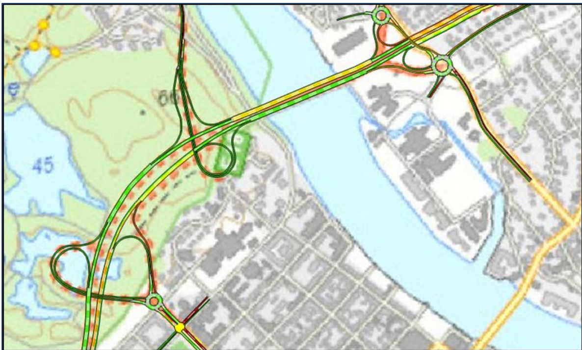
Figur 65: Kapasitet i rampesystemet til Baneheitunnelen i morgenerushet - Basis 2045. Grønn=god avvikling, gul=noe belastet, rød=overbelastet
