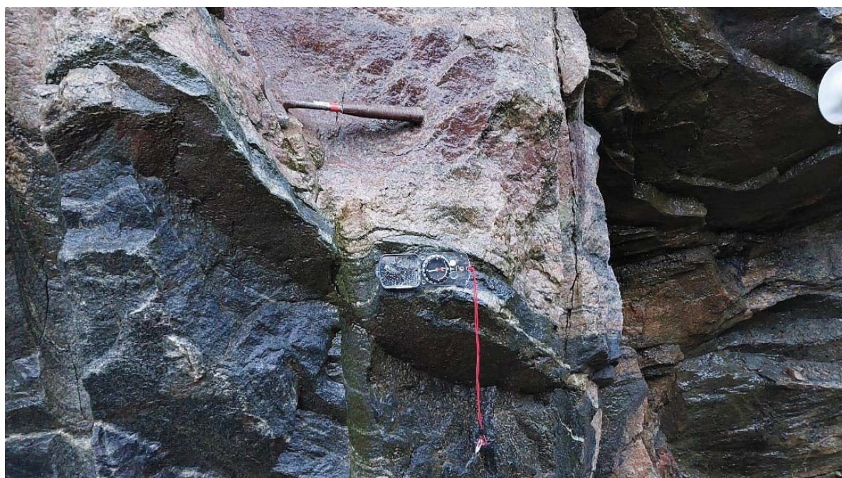
Figur 16: Eksempelbilde av lagdeling ved målepunkt 1 i veiskjæring ved Birkedalsveien med granittisk gneis over amfibolitt. (Foto: Mitta AS/ Eivind Susort)
