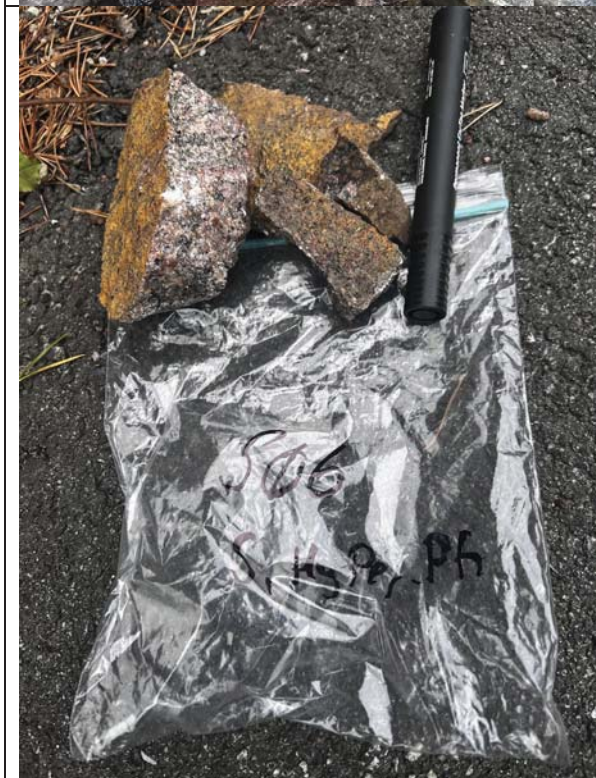
Prøvepunkt SØ6: Bilde av prøve som viser massiv granittisk gneis med gulbrunt sprekkeplan, trolig Goetitt (Jernhydroksid).
