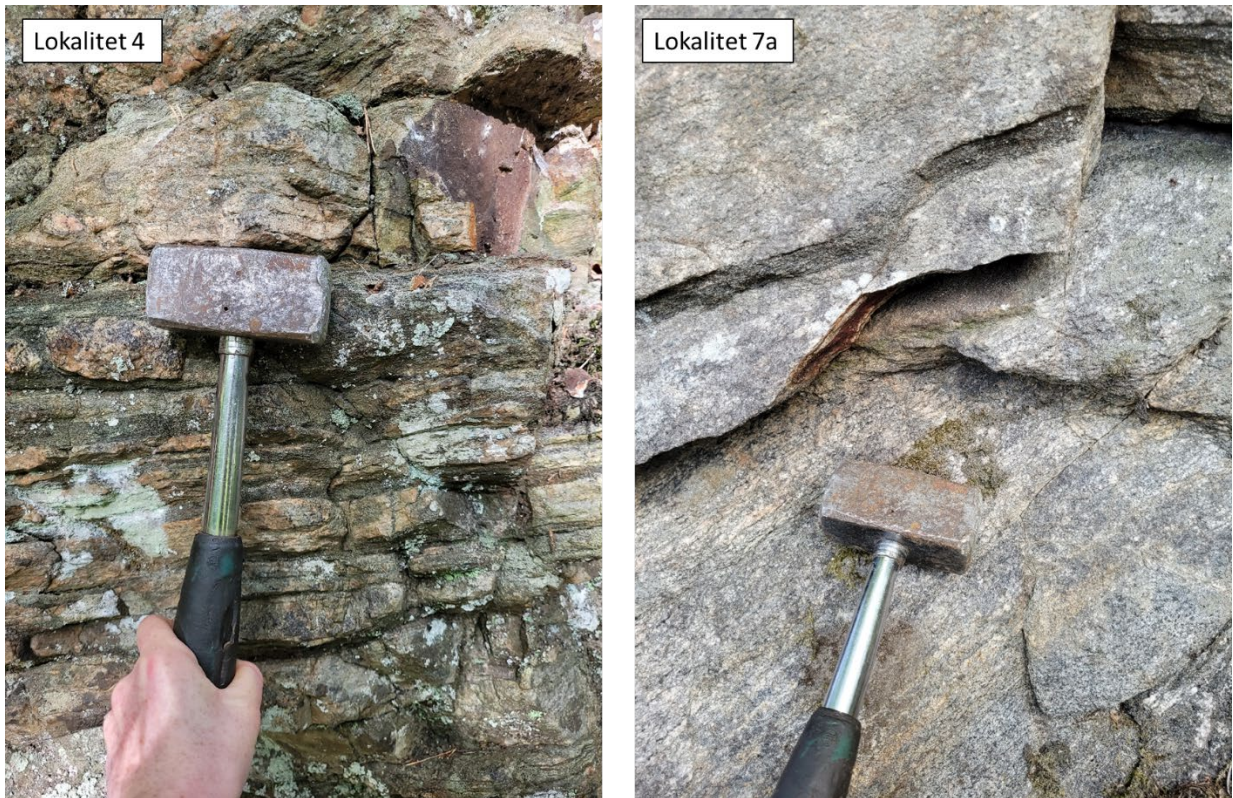
Figur 2-5: Migmatitt med varierende grad av oppsprekking og forvitring.
