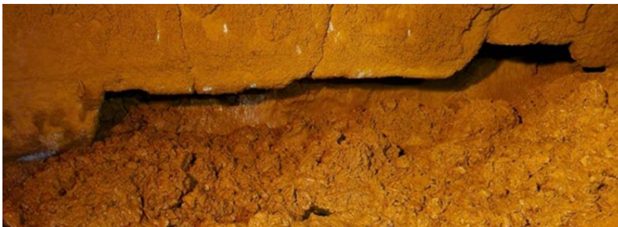
Figur 1 FE-2 slam som deponeres i fjellhallene
