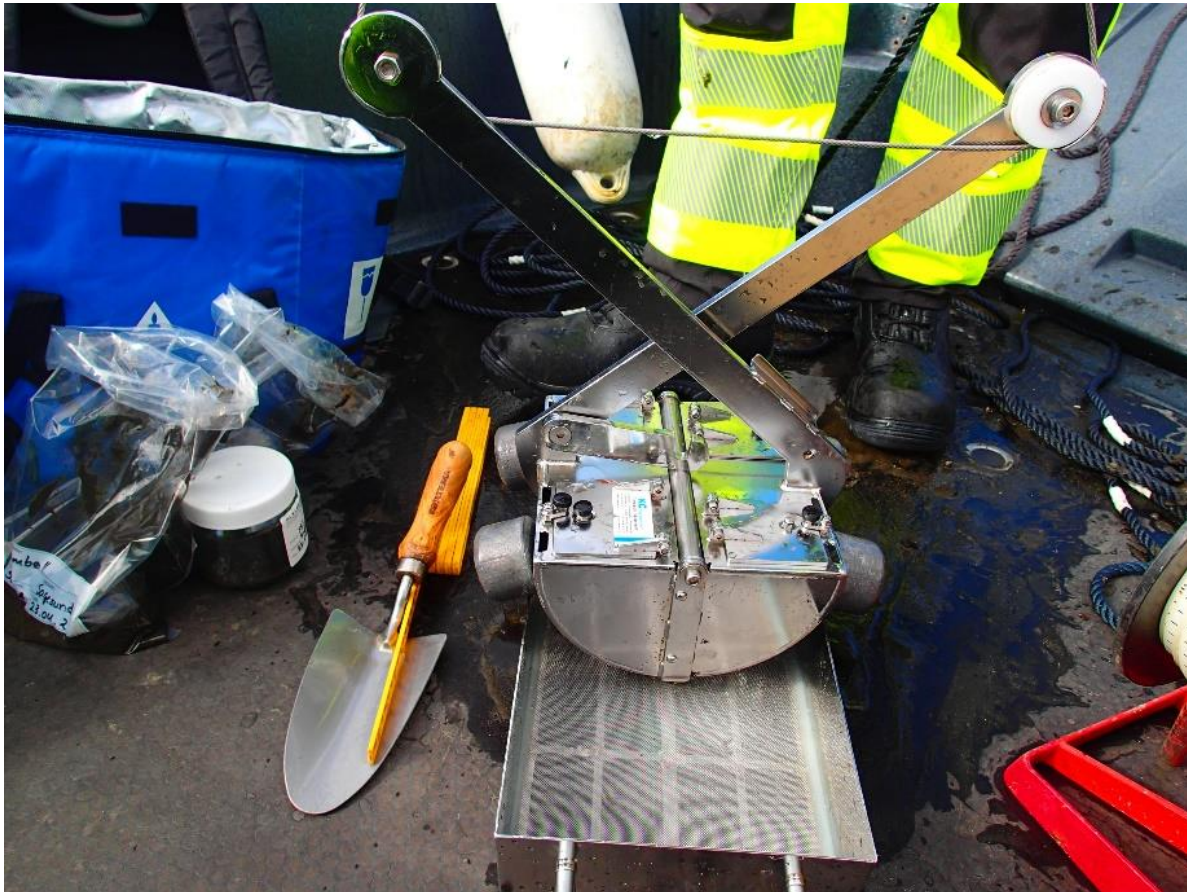
Figur 3: Viser bilde av van veen grabb (250 m 3 ) som ble benyttet ved prøvetaking på lagmannsholmen. Foto: Rambøll
