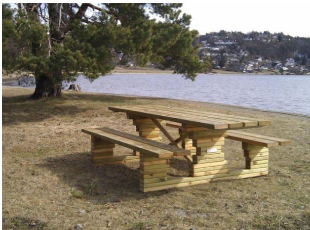
Typebilde: Bord med benk på Hamresanden friluftsområde, tilgjengelig både for rullestolbruker og de som er dårlig til beins. God lengde (250 cm) sikrer at benken kan brukes av ulike grupper samtidig. Foto Helmer Espeland
