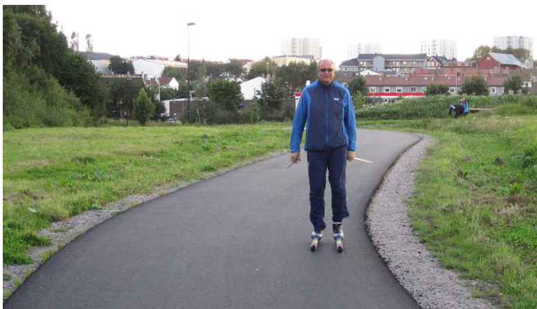
Bildet viser asfaltert flerbruksløype på Kongsgårdjordene, etablert 2012. Merk at veiskulder i utomhusnormalen er 0,5 meter på hver side av veibanen! Foto Helmer Espeland
